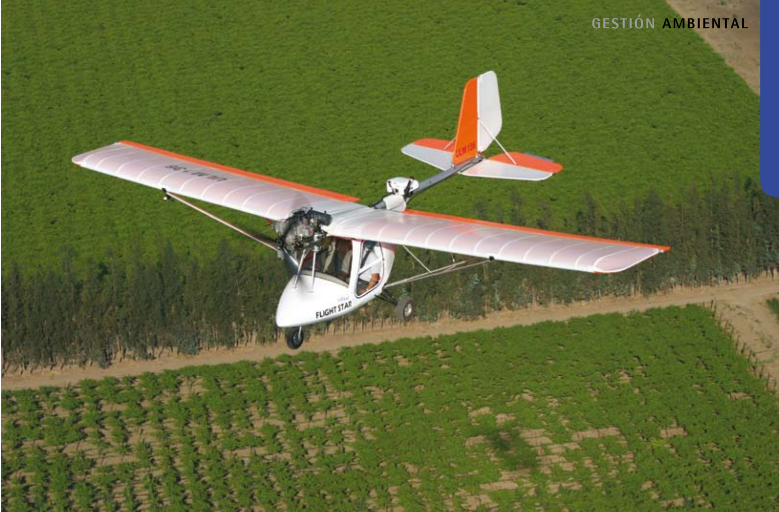
Figura 4: El ultraliviano se caracteriza por sobrevolar áreas a bajas altitudes y a baja velocidad, favoreciendo la adquisición de imágenes hiperspectrales e hiperespaciales de la superficie.
